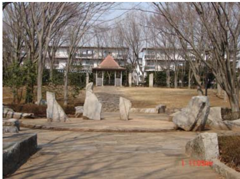
写真7 鋭い角をもった見にくい段差。 吾妻2丁目団地内
