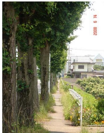
写真4 生長して歩道をふさぎ根による地盤持ち上げが起きている街路樹
