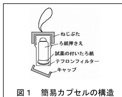
図1 簡易カプセルの構造
